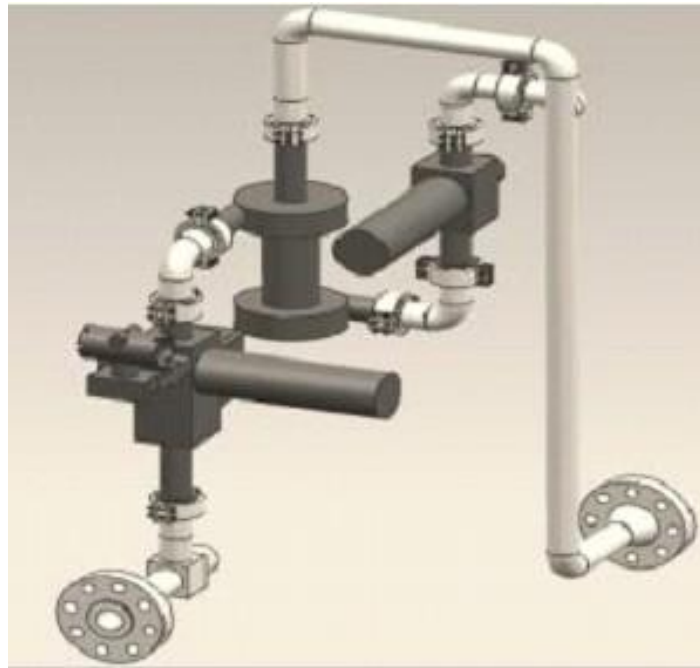
Wet Gas Meter
